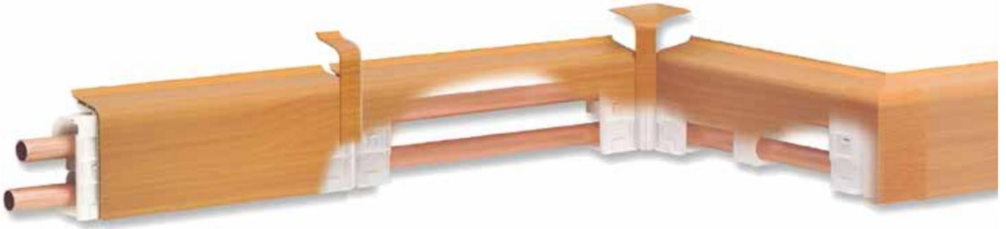
Das SLF 2000 Profil ist das universelle Sockelleistenprofil für Rohre bis  $\varnothing 22$  mm. Es ist ein stabiles Kunststoffhohlkammerprofil mit einer Dichtlippe zur Wand, um Unebenheiten auszugleichen. Das Profilmaterial ist langlebig und extrem schlagfest. Die Befestigung des Profils erfolgt nach dem Verlegen der Rohre mit der Schelle 2150 (Art.-Nr. 10745412) oder vor dem Verlegen der Rohre mit der Schelle 2250 (Art.-Nr. 10745408). Die Befestigung der Schellen erfolgt z. B. mit Nagelübeln.
